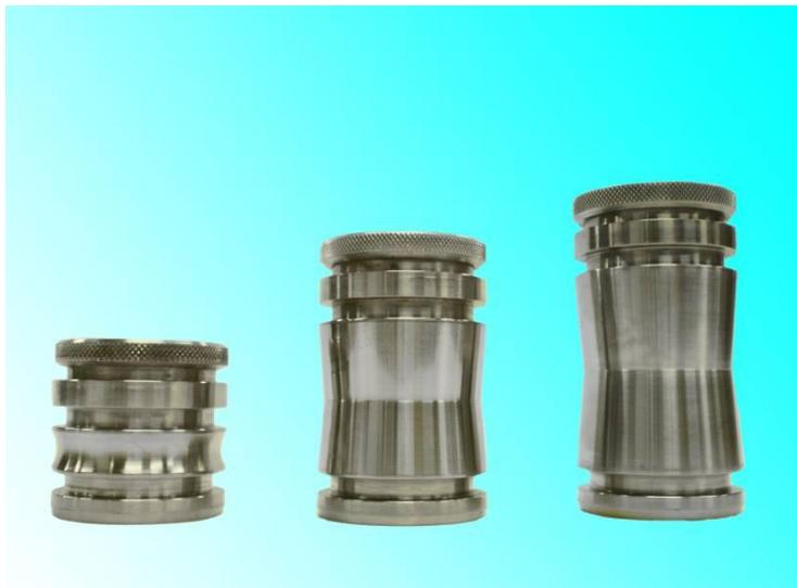
ソニックノズルは気体の流れの音速域（臨界流）の性質を利用したベンチュリー形状の画期的な流量計です。その規則性は既に立証されております。また流量値の検定について超精密加工ノズルに依るクロスチェックや産業技術総合研究所の検定装置とのクロスチェック等、常に信頼性を確立しつつ製作にあたっております。
